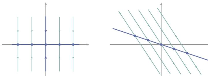
Abb 4 Entarteter stabiler Knoten, diagonalisierbar
