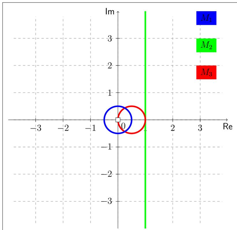
Die Funktion  $f_1$  beschreibt eine Drehstreckung bestehend aus einer Streckung um den Faktor  $\sqrt{3^2 + 4^2} = 5$  und einer Drehung um den Winkel  $\arg(3 + 4i) = \arctan\left(\frac{4}{3}\right) \approx 0.295\pi \approx 53.13^\circ$ . Wir berechnen explizit das Bild von  $M_3$ :
