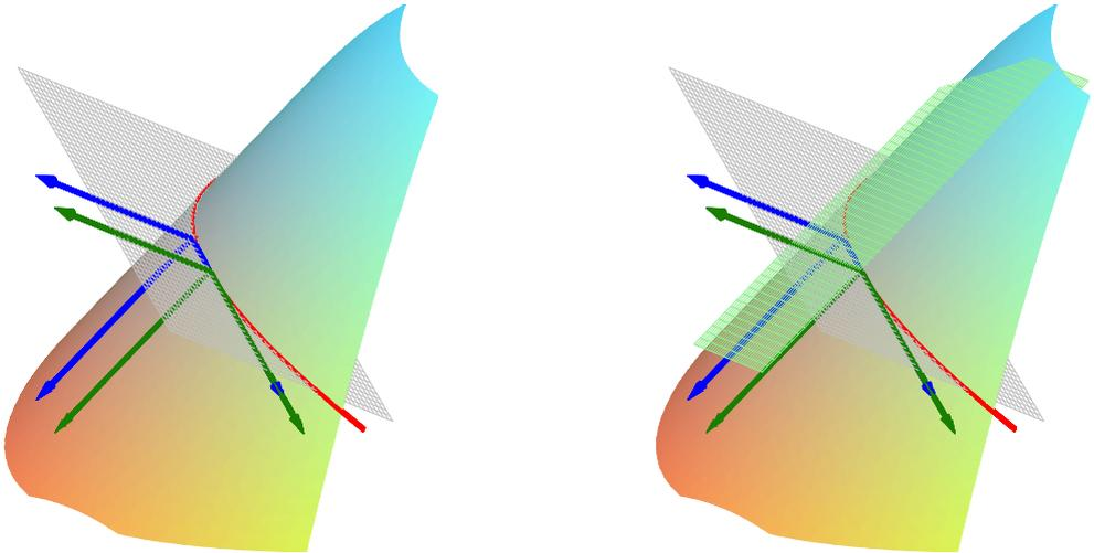
Abbildung 6.6: Die Quadrik mit den Systemen  $\mathbb{F}$  und  $\mathbb{G}$ . Die von  $f_1$  und  $f_2$  aufgespannte Ebene schneidet die Quadrik in einer Parabel (links), die von  $f_2$  und  $f_3$  aufgespannte Ebene durch den neuen Ursprung  $P$  ist eine Symmetrieebene der Quadrik.
